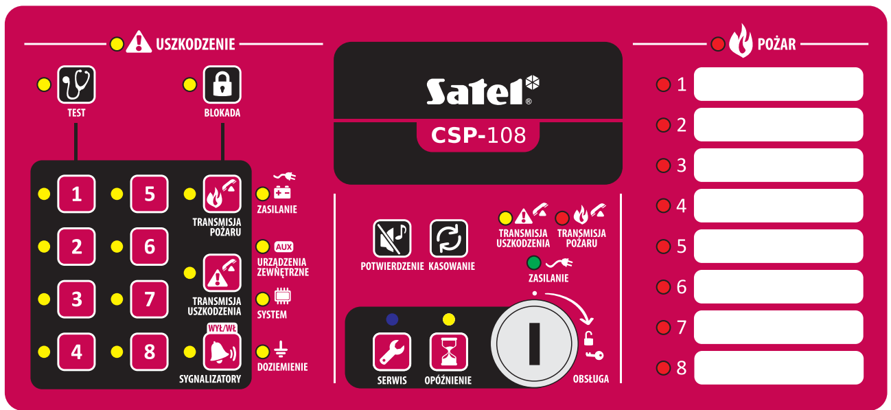
Rys. 6. Panel czołowy centrali CSP-108.
